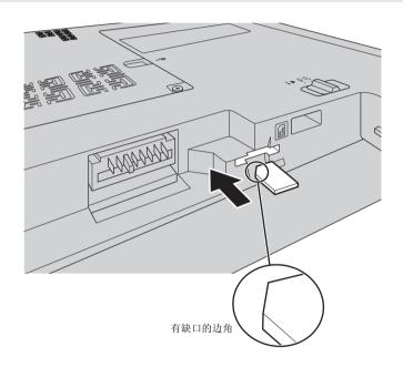
5 将电池装好,把电脑翻转回原位并重新连接电缆线。
