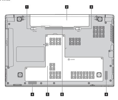
1 电池锁扣 手动式电池锁扣可固定电池模组。 手动式
